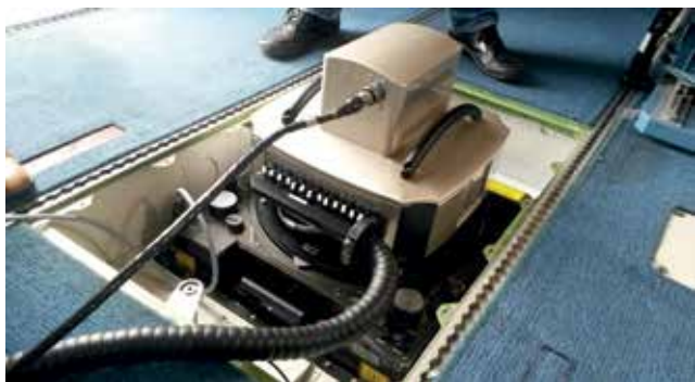
Figura 2. Ultracam Eagle montada en el TR.19
