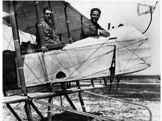
Figura 2. El capitán Antonio Domínguez Olarte (que sería Jefe del Gabinete fotográfico de Aviación Militar en el año 1925-26) y el capitán Ángel Martínez-Baños Ferrer en un avión Farman 7. Esta preciosa fotografía tiene el atractivo añadido de poder ver montado, en el ángulo superior derecho, el "indicateur de vitesse Etévé", lo que nos da una idea de la dificultad (y la buena vista) que debían tener los pilotos para controlar la velocidad. La presión del viento movía las laminillas conectadas a la aguja indicadora sobre la escala que indicaba la velocidad que, todo hay que decirlo, no era de lo más precioso
