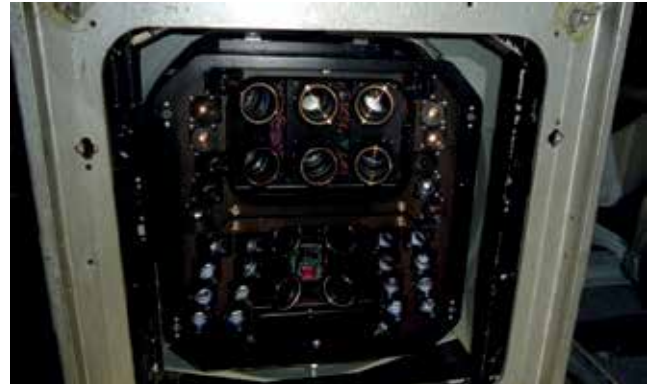
Figura 11. Configuración de lentes en el dispositivo de la cámara del avión ruso TU-152 de Open Skies
