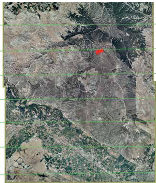
Figura 2.1. Vuelo escala 1:30 000 sobre Zaragoza (pasadas en verde). Se representa un vuelo del Gatewing X-100 de Trimble (rojo) de 400 imágenes
